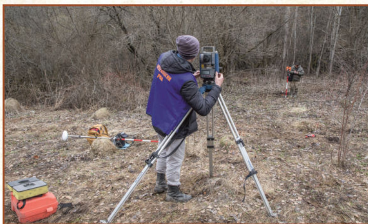
Геодезист ИА РАН ведёт фиксацию находок с помощью тахеометра
